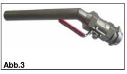
Mit speziellen Abfüllrohren wird ein maximales Abpumpen der Flüssigkeit erreicht. Ein Verschlusskegel garantiert, dass die eingeströmte Flüssigkeit wieder in den Behälter zurückläuft. Das Verschließen erfolgt über einen kleinen Handhebel.
